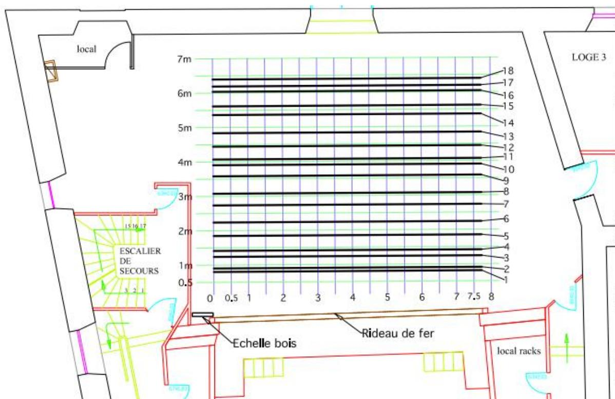
Le théâtre est équipé de 18 perches manuelles d'une charge maximale de 60Kg chacune.
